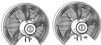
Σημείωση: Είναι σημαντικό ο Στύλος (7) και η κεφαλή της συσκευής να είναι στη σωστή διεύθυνση όταν συναρμολογείτε τη συσκευή.
